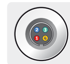
Pin Layout (Instrument) Steckerbelegung • Schéma des connexions • Diagrama de conexiones
